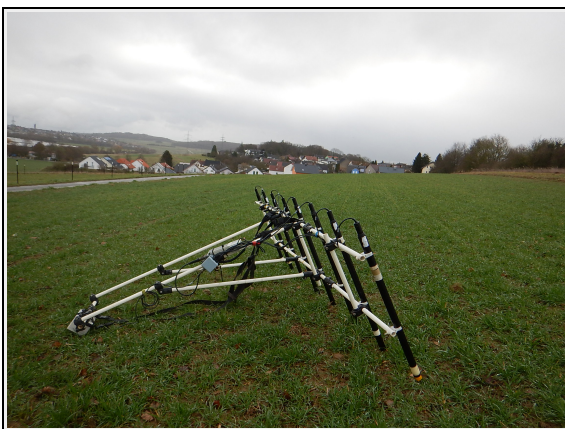
Fotos: Mehrkanalige Fluxgate-Magnetometer mit Sonden der Fa. Sensys
