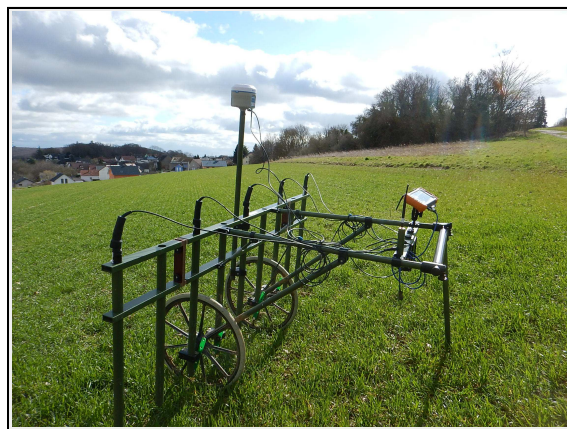
Fotos: Mehrkanalige Fluxgate-Magnetometer mit Sonden der Fa. Sensys
